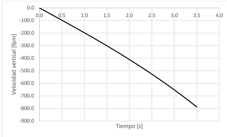
Figura 9.8. Velocidad vertical del avión en la maniobra de descenso.
